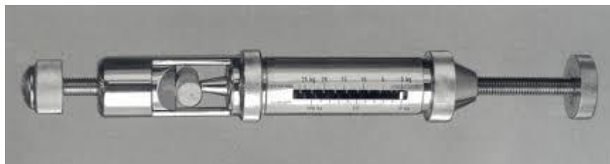
Slika 14. Ispitivanje izdržljivosti peleta pomoću opruge
