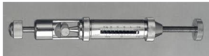
Slika 14. Ispitivanje izdržljivosti peleta pomoću opruge
