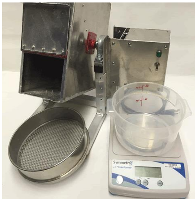
Slika 13. Uređaj za ispitivanje izdržljivosti peleta
