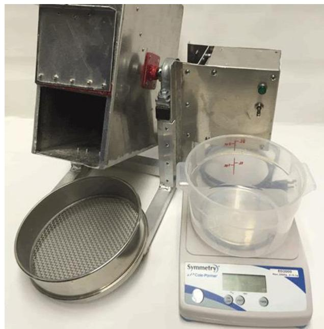
Slika 13. Uredaj za ispitivanje izdržljivosti peleta
