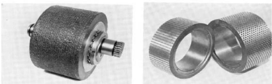
Slika 6. Tri osnovna tipa površina za valjke
