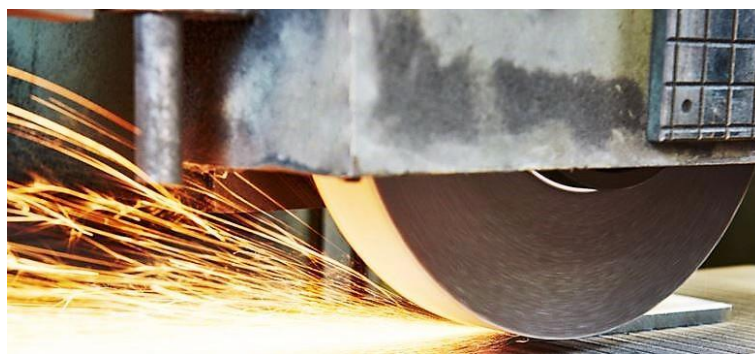
Slika 10. Ravno brušenje aluminijskih ploča ( https://www.clintonaluminum.com/grinding-aluminum-sheets-and-plates/ )
