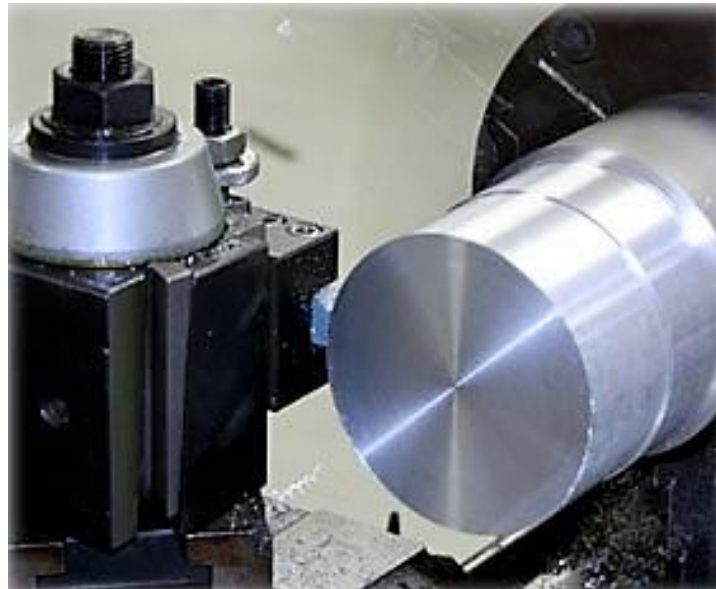
Slika 7. Tokarenje aluminijskog cilindra ( http://lesmillerdesigns.com/machining.html )
