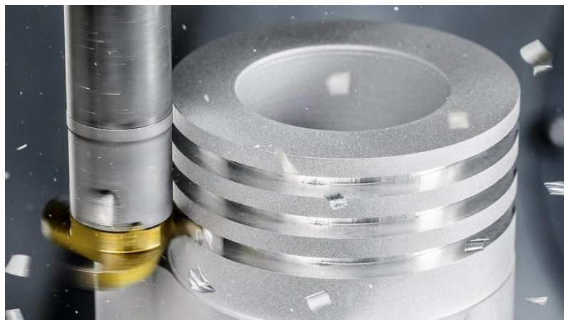
Slika 8. Glodanje aluminijskog klipa motora SUS ( https://www.nc-fertigung.de/besser-fraesen-in-aluminium )
