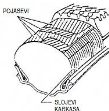
Slika 9. Shema konstrukcije pneumatika
