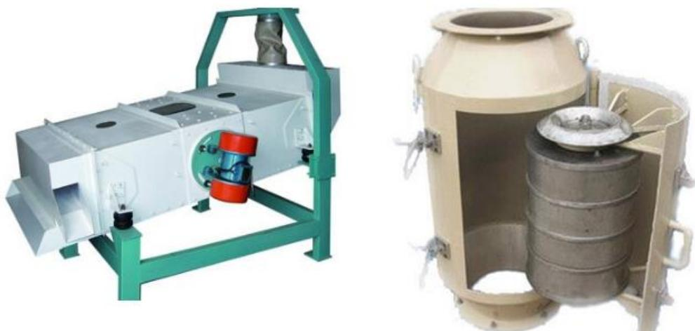
Slika 1. Sito za čišćenje ulja i magnetski separator
