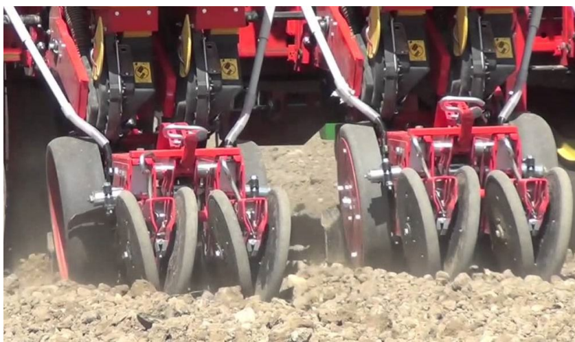
Slika 21. Nagazni kotači sijačice MaterMacc Twin row-2 u radu
