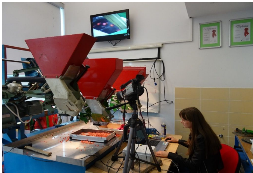
Slika 25. Ispitni stol za provjeru kvalitete rada pneumatskih sijačica
