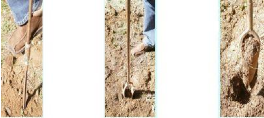
Slika 6. Uzorkovanje sondom i svrdlom (FAZ, 2011).
