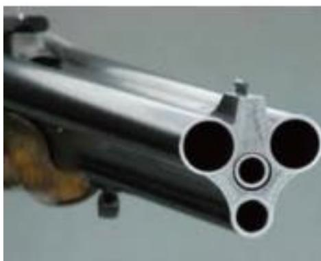
Slika 21. Risanica četverocijevka, usta cijevi
