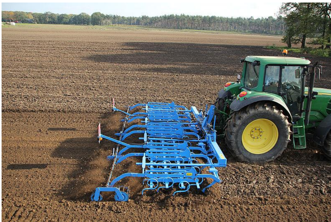
Slika 9. Priprema tla sjetvospremačem
