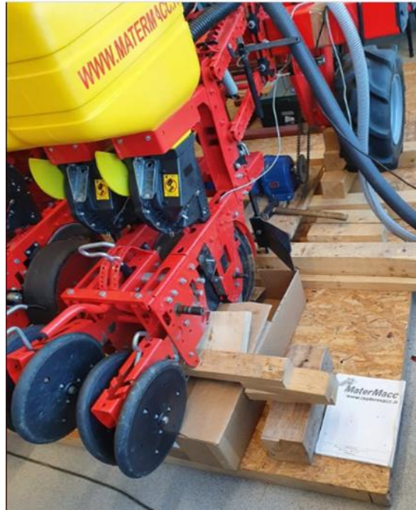
Slika 5. Sjetvene sekcije sijačice MaterMacc Twin Row - 2
