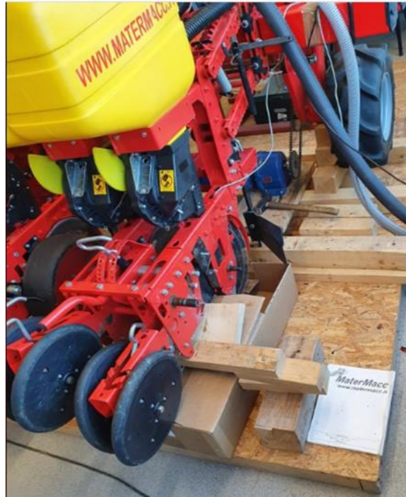
Slika 5. Sjetvene sekcije sijačice MaterMacc Twin Row - 2
