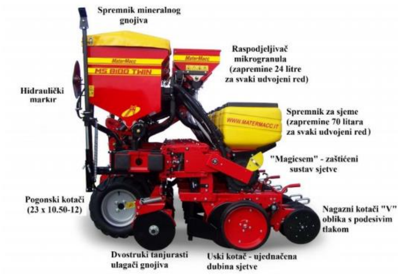
Slika 3. Glavni sustavi sijačice MaterMacc Twin Row - 2
