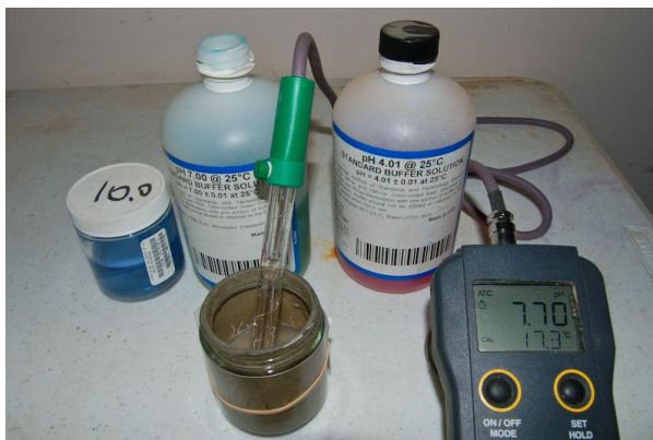
Slika 2.: Elektrometrijsko mjerenje pH metrom
