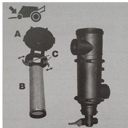
Slika 20. Čišćenje Ciklon pročistača (Hardi Commander Twin Force, 2013).
