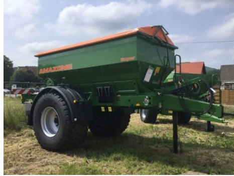
Slika 18. Rasipač Amazone ZG-B 8200 SUPER (izvor: autor).
