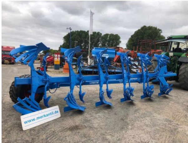
Slika 5. Plug Lemken VariOpal šesterobrazdni (izvor: autor)
