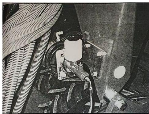
Slika 10. Glavni kočioni cilindar sa spremnikom za tekućinu (Horsch Pronto 3-6 DC, 2016.).
