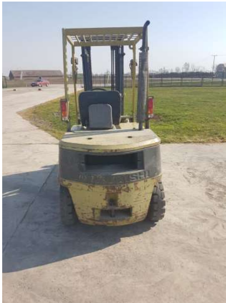
Slika 21. Protuuteg viličara (Izvor: Lukačević, M.)
