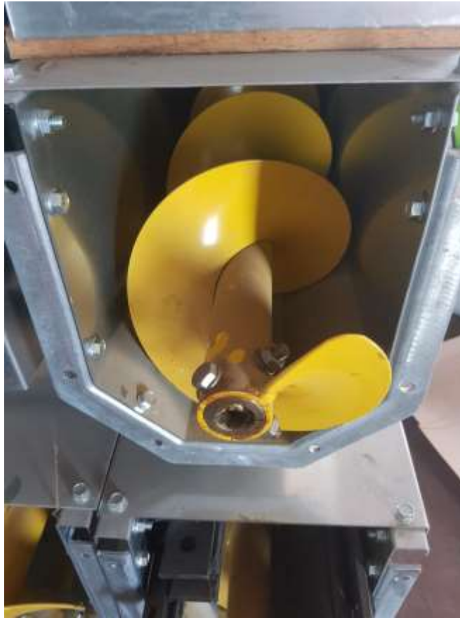
Slika 37. Puna zavojnica puža (Izvor: Lukačević, M.)
