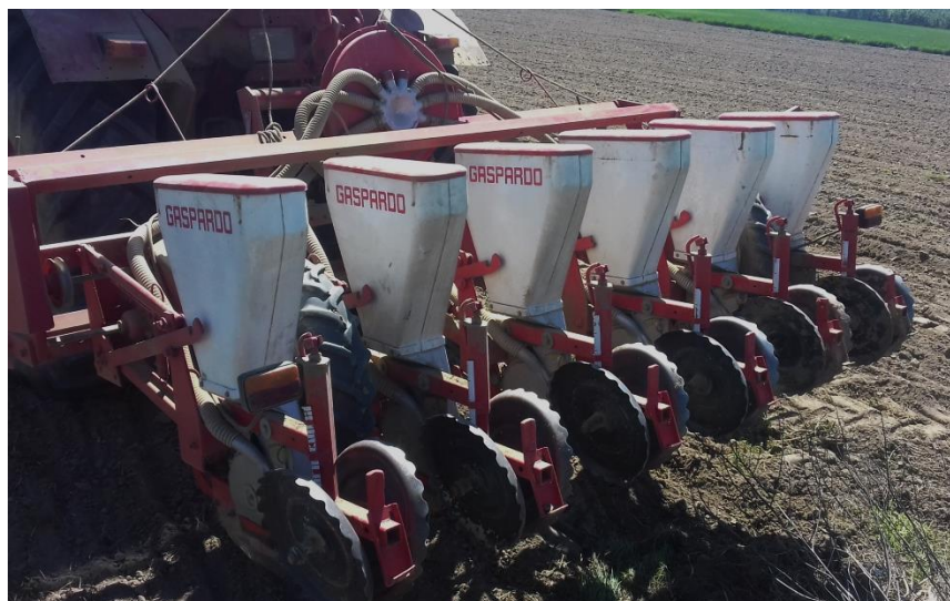
Slika 4. Sijačica za sjetvu soje na razmak 45 cm (Izvor: Emanuel Sigurnjak, 2019.)
