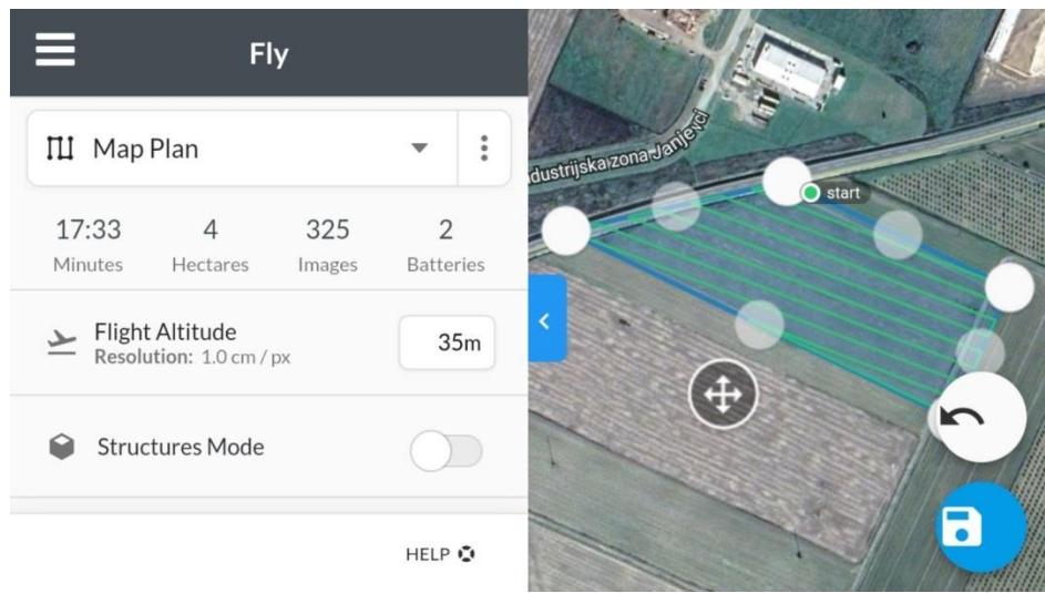
Slika 6. Određivanje visine leta bespilotnim zrakoplovom
