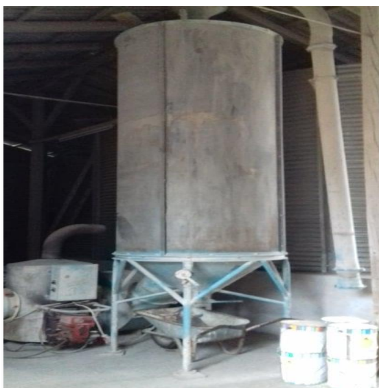
Slika 10. Mali silos s konusnim dnom
