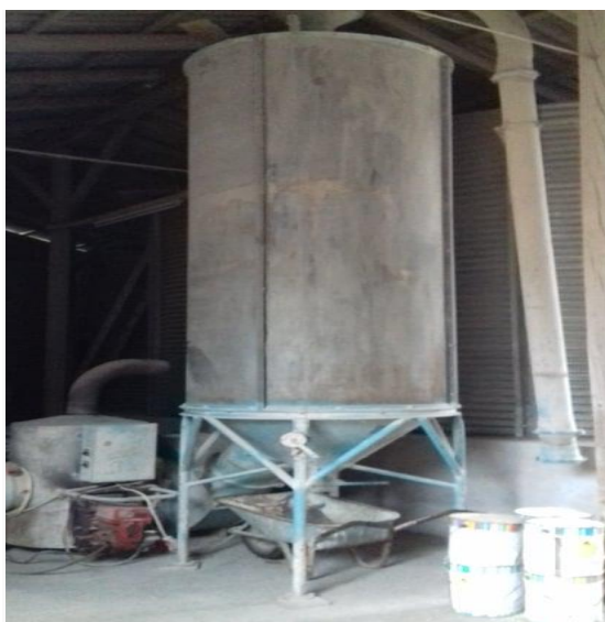
Slika 10. Mali silos s konusnim dnom
