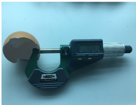
Slika 9. Mjerenje debljine ljuske
