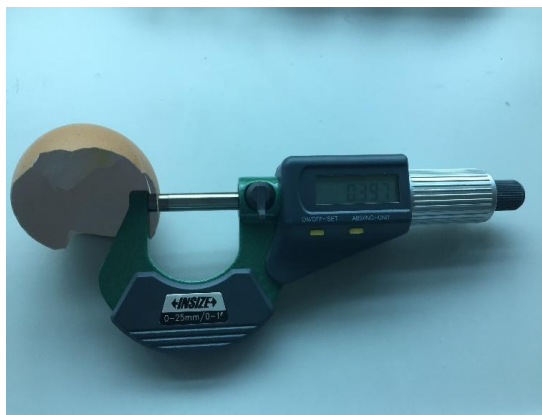
Slika 9. Mjerenje debljine ljuske
