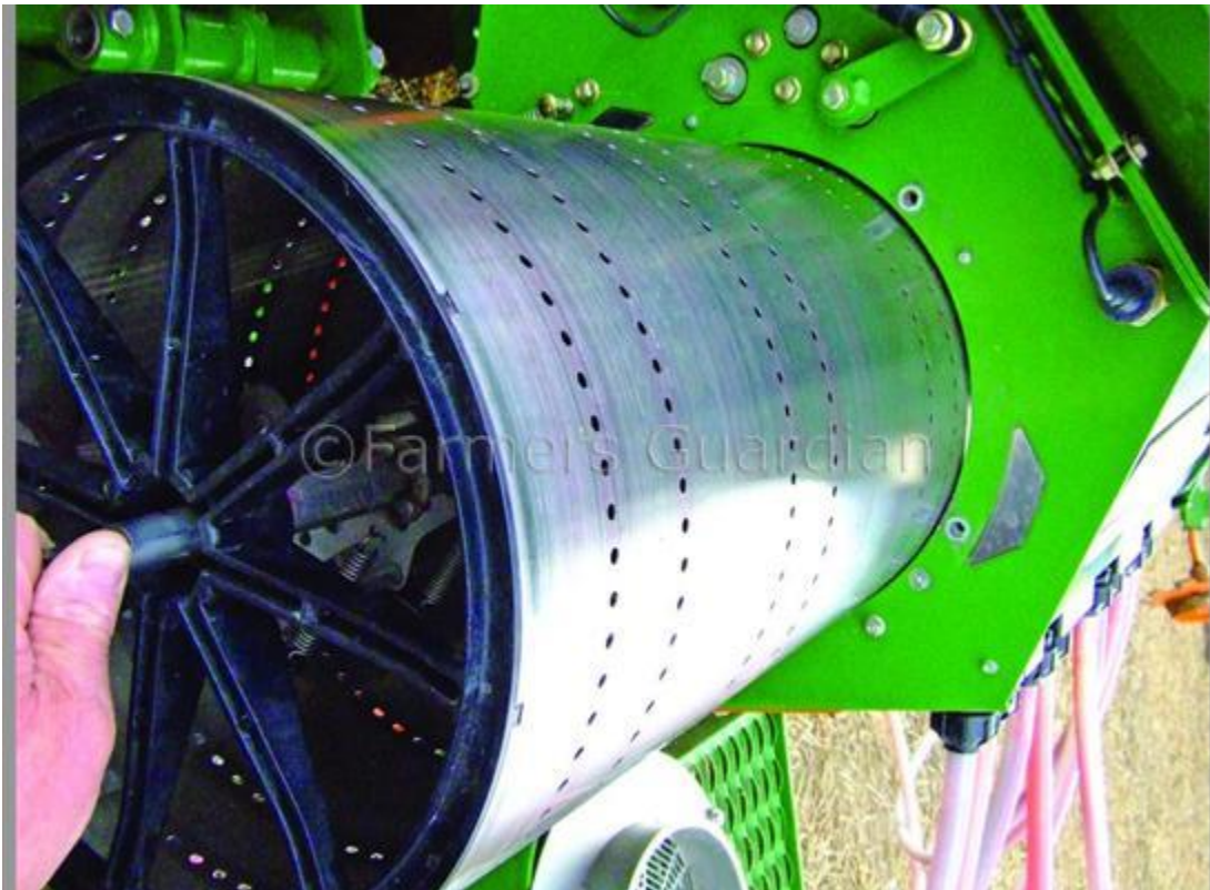
Slika 18. Bubanj Amazone EDX sjetvenog uređaja [18]
