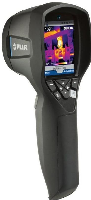
Slika 5. Infracrvena termovizijska kamera FLIR i7
