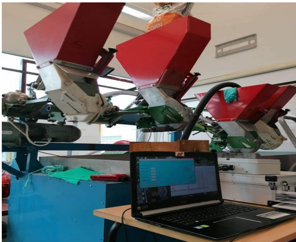
Slika 9. PSK - OLT sijačica na ispitnom stolu
