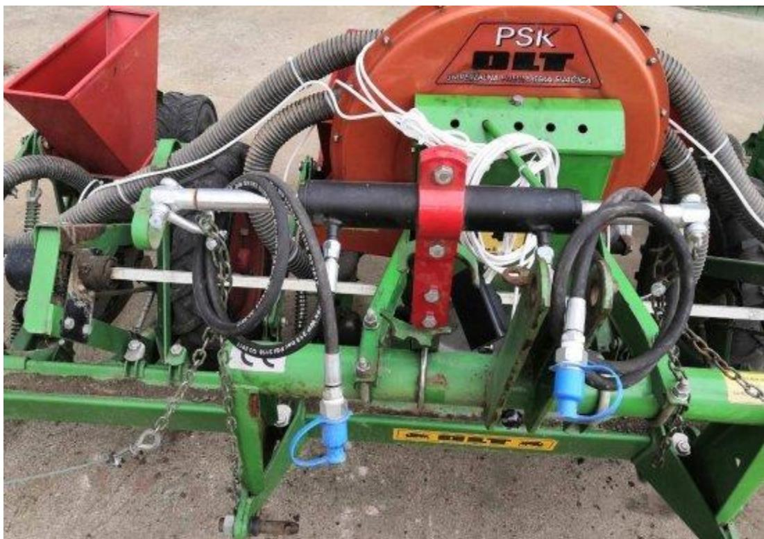
Slika 6. Hidraulični marker PSK – OLT sijačice
