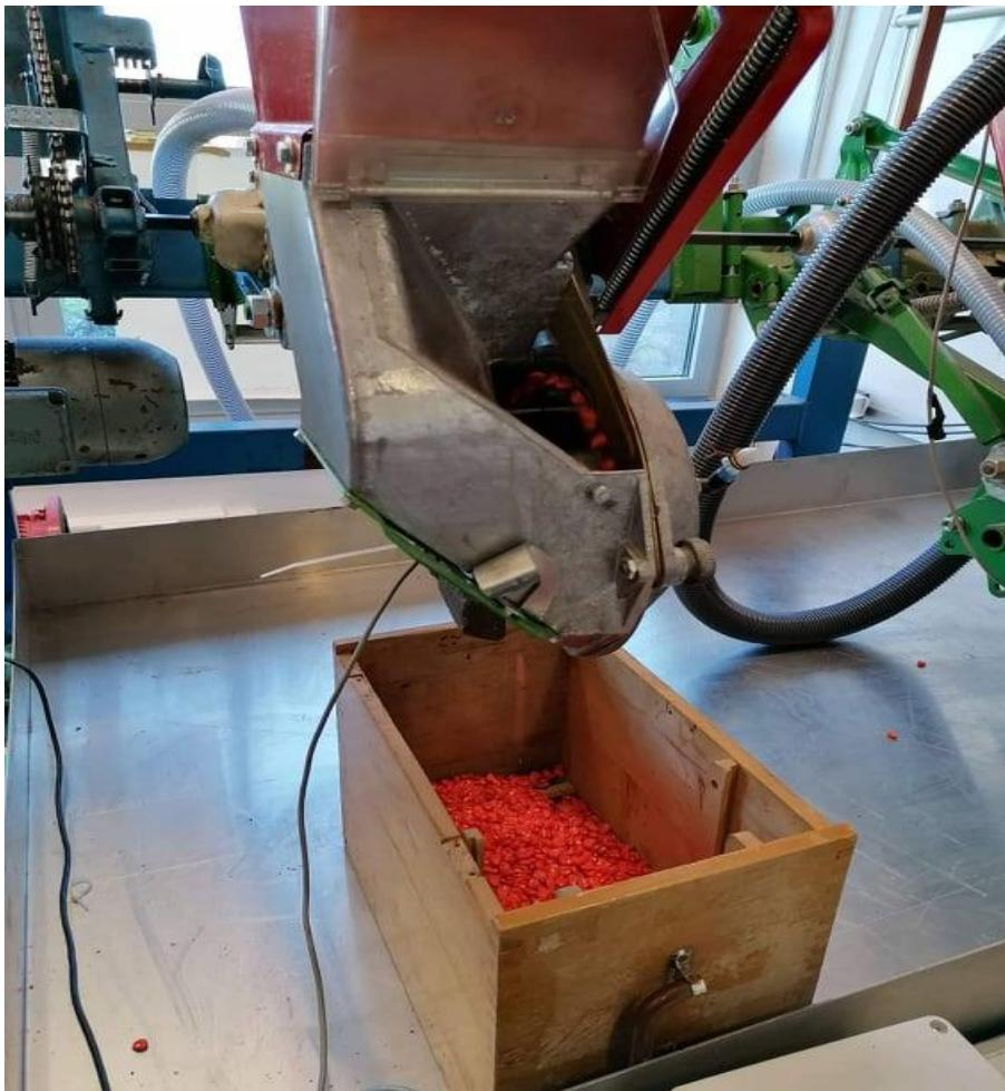
Slika 5. Sjetveni aparat *PSK - OLT* sijačice
