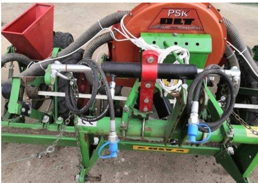
Slika 6. Hidraulični marker PSK – OLT sijačice
