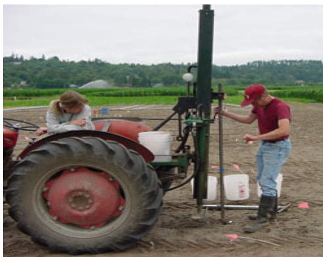
Slika 2. Priključna hidraulička sonda
