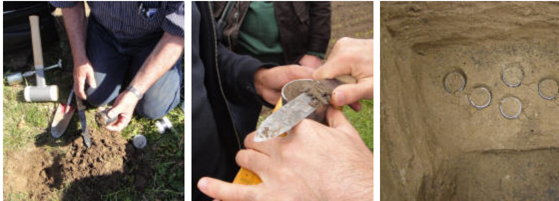
Slika 18. Uzimanje uzoraka Kopecky-evim cilindrima
