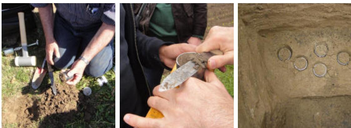
Slika 18. Uzimanje uzoraka Kopecky-evim cilindrima
