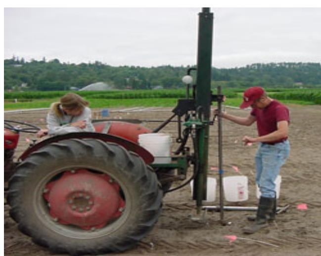
Slika 2. Priključna hidraulička sonda
