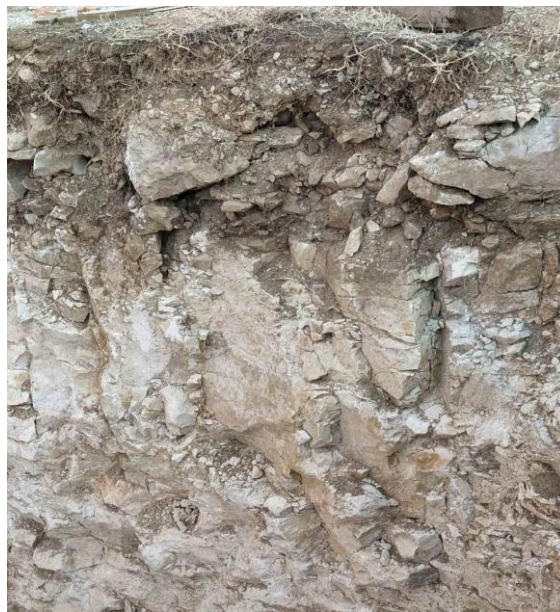
Slika 3. Profil tla melioriranog krša (Izvor: Zorica M., arhiva projekta SAN, 2019.)
