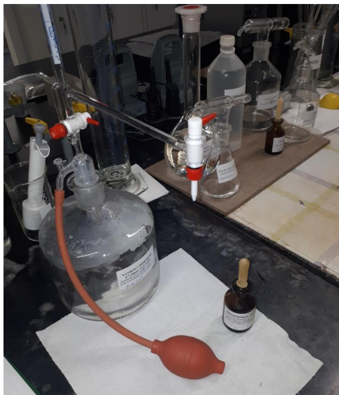
Slika 10. Određivanje ukupnih kiselina u moštu titracijom
