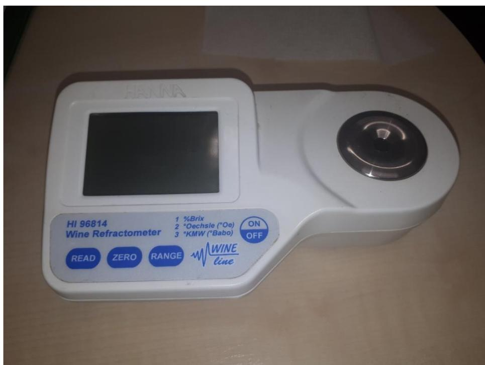
Slika 8. Refraktometar- uređaj za mjerenje šećera
