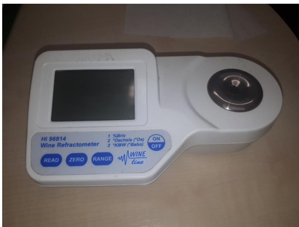
Slika 8. Refraktometar- uređaj za mjerenje šećera
