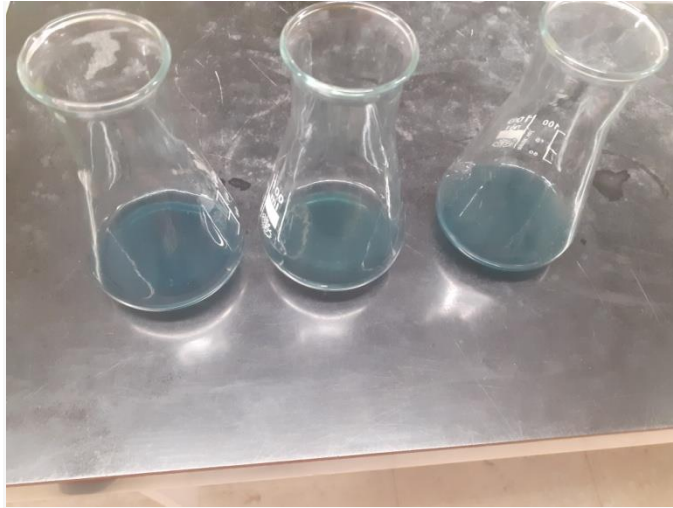
Slika 10. Određivanje ukupne kiselosti mošta titracijom (Autor, 2019.)
