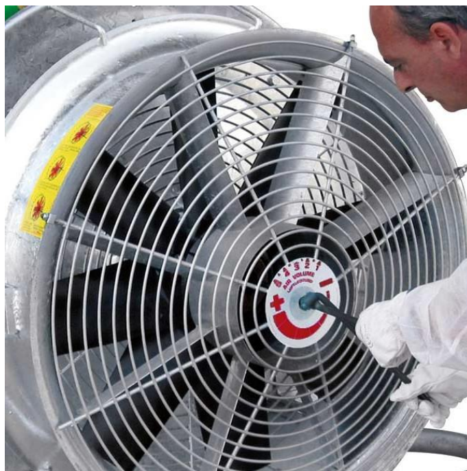
Slika 7. Ventilatorski sustav raspršivača Tifone VENTO - 1000
