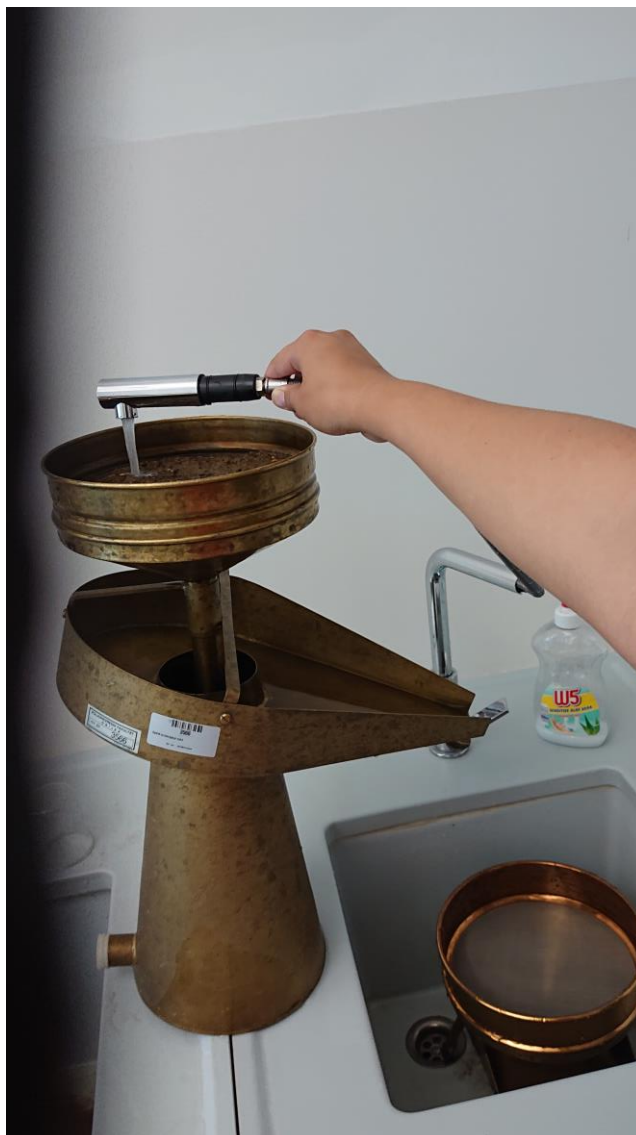
Slika 12. Ispiranje uzoraka tla Fenwickovim aparatom
