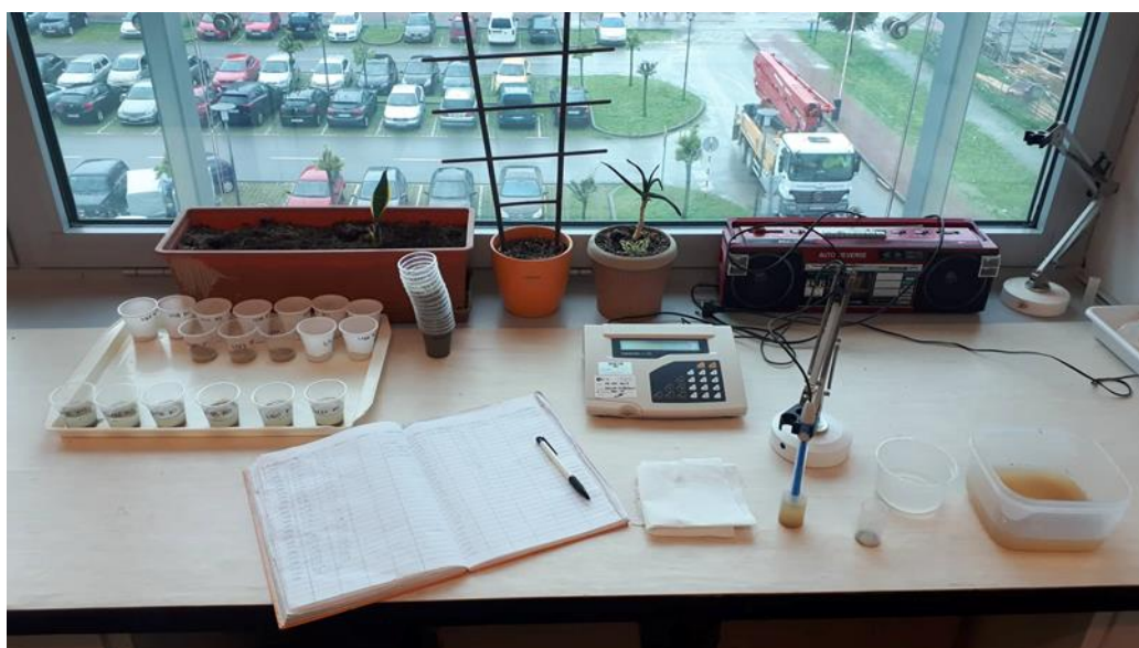
Slika 3.6. Očitavanje pH vrijednosti (Izvor: Doris Doljanac)
