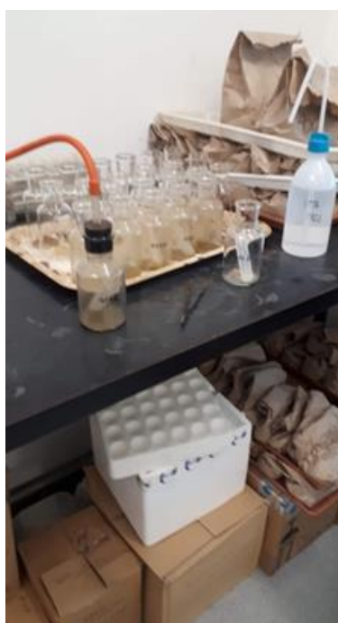
Slika 3.10. Volumetrijska metoda određivanja karbonata (Izvor:Doris Doljanac)
