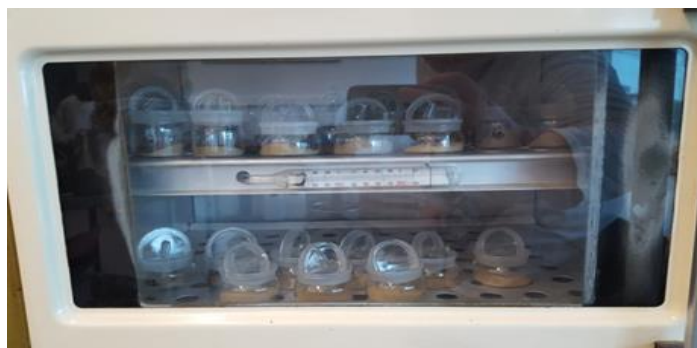
Slika 3.11. Isušivanje uzoraka ( Izvor:Doris Doljanac)
