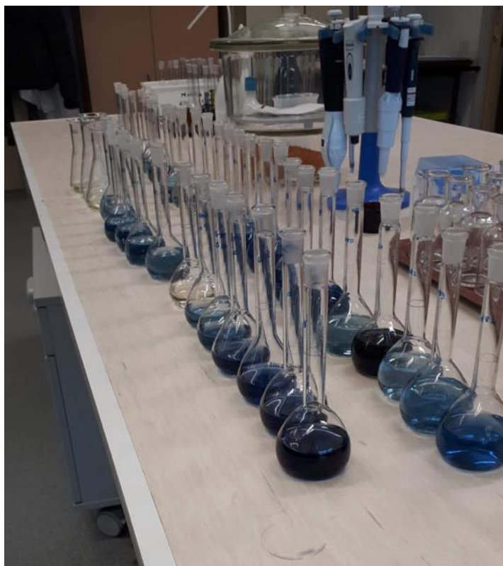
Slika 3.8. Razvijen kompleks plave boje za analizu fosfora (Izvor:Doris Doljanac)
