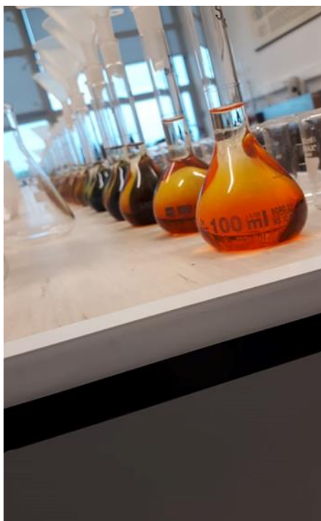
Slika 3.7. Određivanje organske tvari bikromatnom metodom (Izvor:Doris Doljanac)
