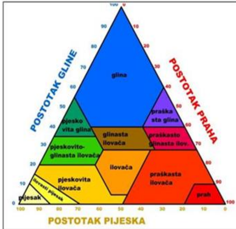
Slika 3.13. Teksturni trokut ((Soil Survey Staff, 1951.)
