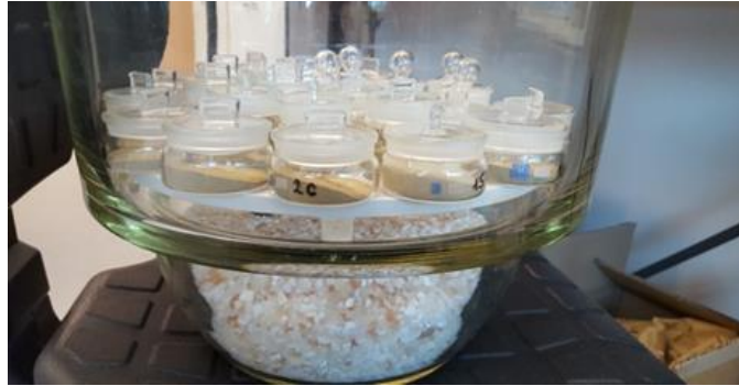
Slika 3.12. Hlađenje u vakuum eksikatoru (Izvor:Doris Doljanac)
