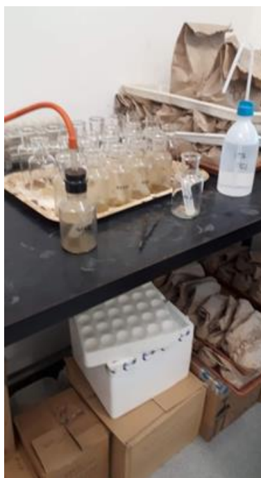
Slika 3.10. Volumetrijska metoda određivanja karbonata (Izvor:Doris Doljanac)
