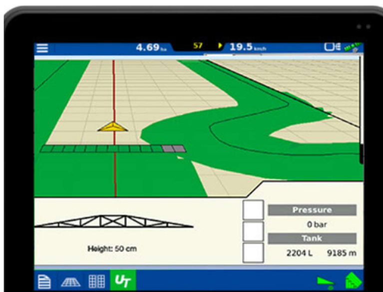
Slika 9. AutoSectionControl za automatsko otvaranje i zatvaranje malznica
