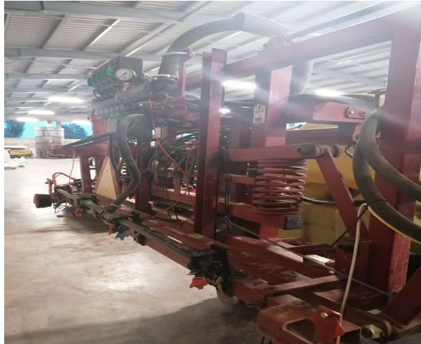
Slika 13. Krila prskalice Hardi Ranger 2500 (Izvor: https://hardi-international.com )
