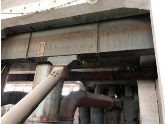
Slika 26. Lančani transporter (Izvor: slikao autor)
