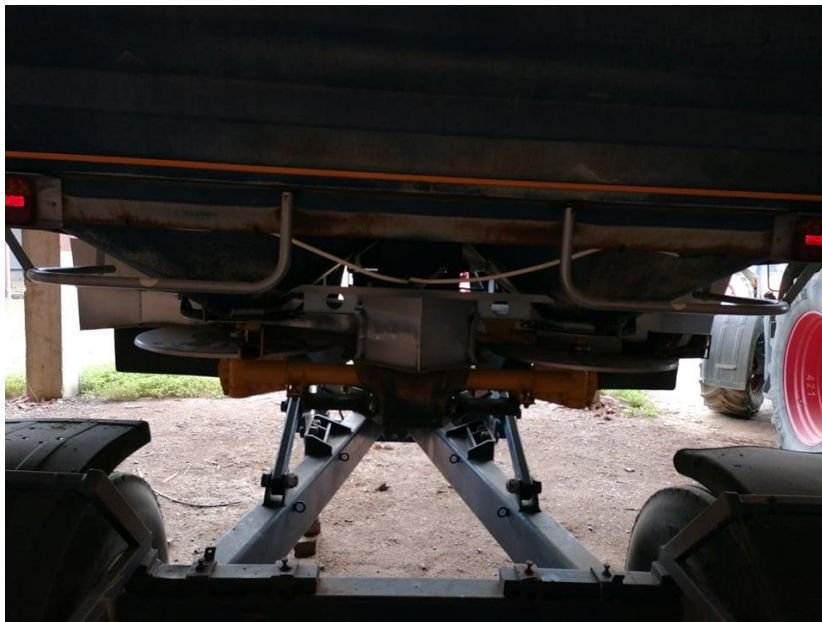
Slika 11. Diskovi na Bogballe rasipaču
