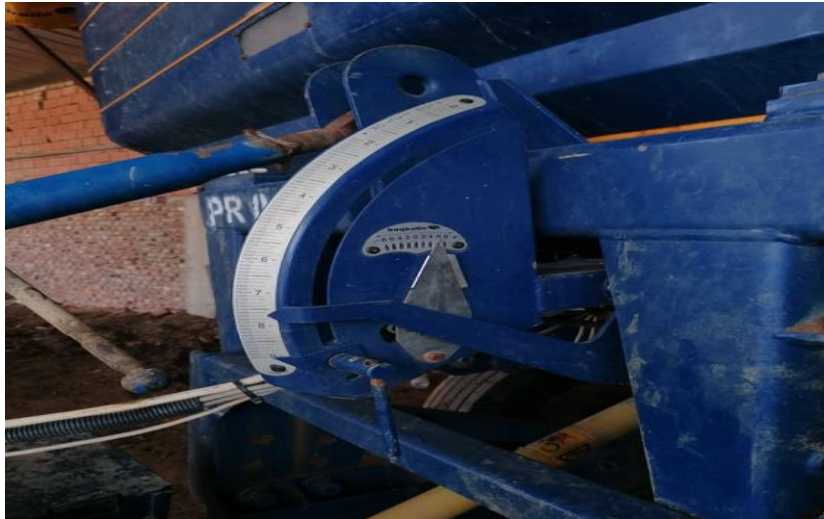
Slika 12. Namještanje kuta zakošenja rasipača
