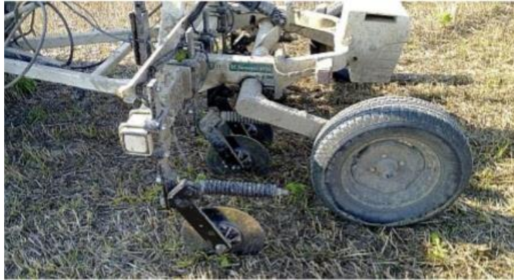
Slika 1. Skener elektrovodljivosti tla Veris EC Surveyor 3150
