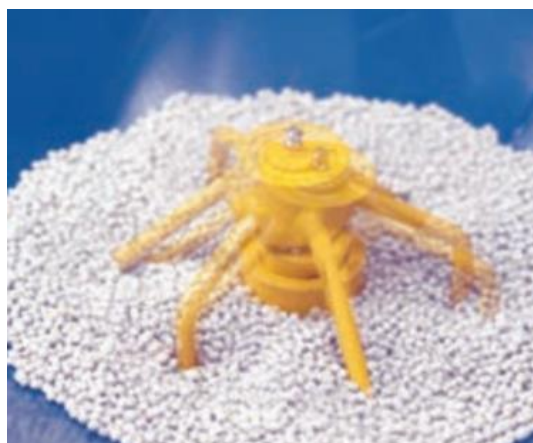
Slika 10. Mješač gnojiva na raspodjelivaču Bogballe M3W
