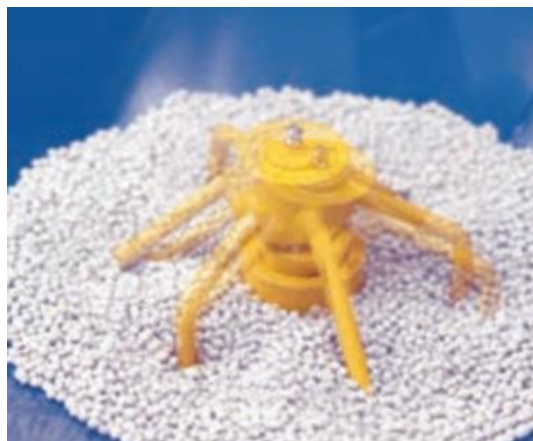
Slika 10. Mješač gnojiva na raspodjelivaču Bogballe M3W
