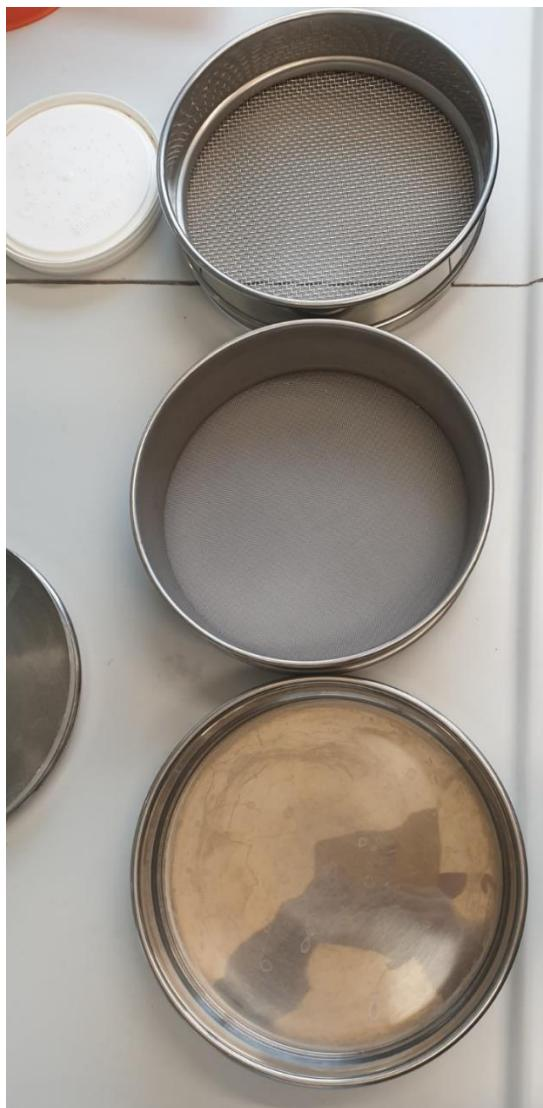
**Slika 5.** Sita za prosijavanje uzoraka
