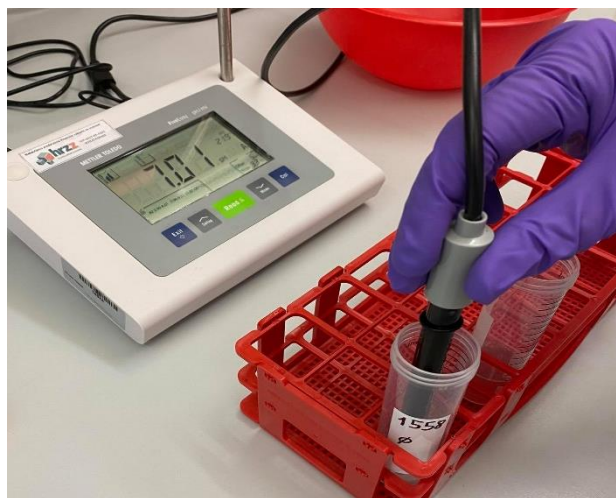
Slika 5. Mjerenje pH vrijednosti (M. Mikulić)
