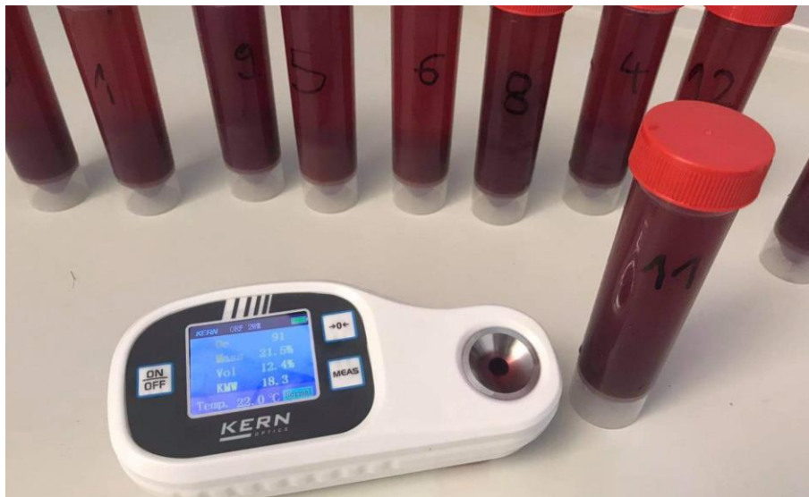
Slika 6. Određivanje šećera refraktometrom (M. Mikulić)
