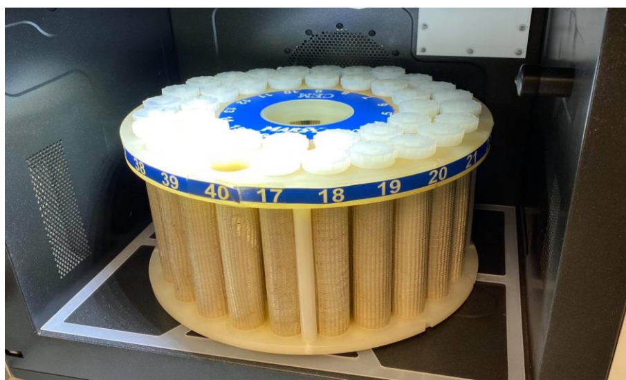
Slika 7. Razaranje uzoraka u mikrovalnoj peći (M. Mikulić)
