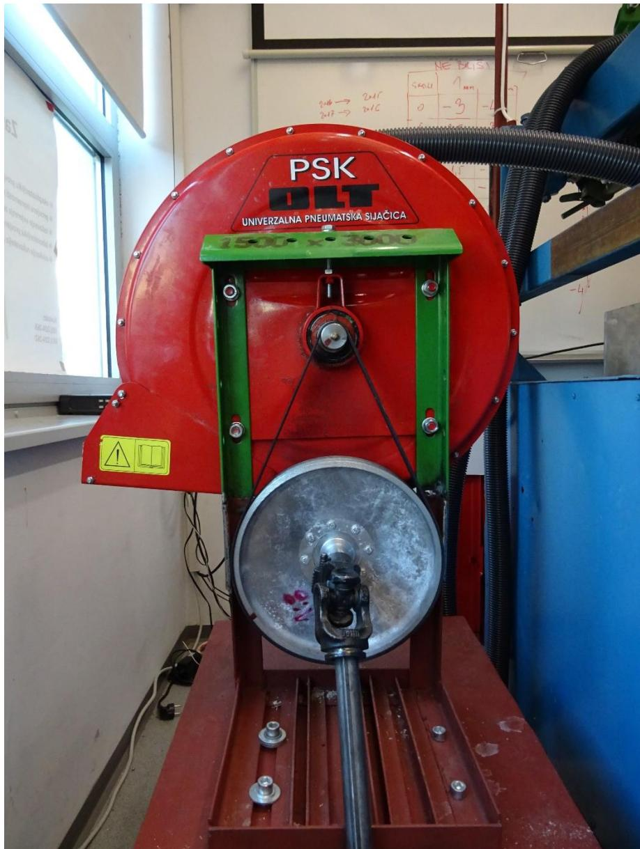
Slika 13. Radijalni ventilator sijačice PSK4
