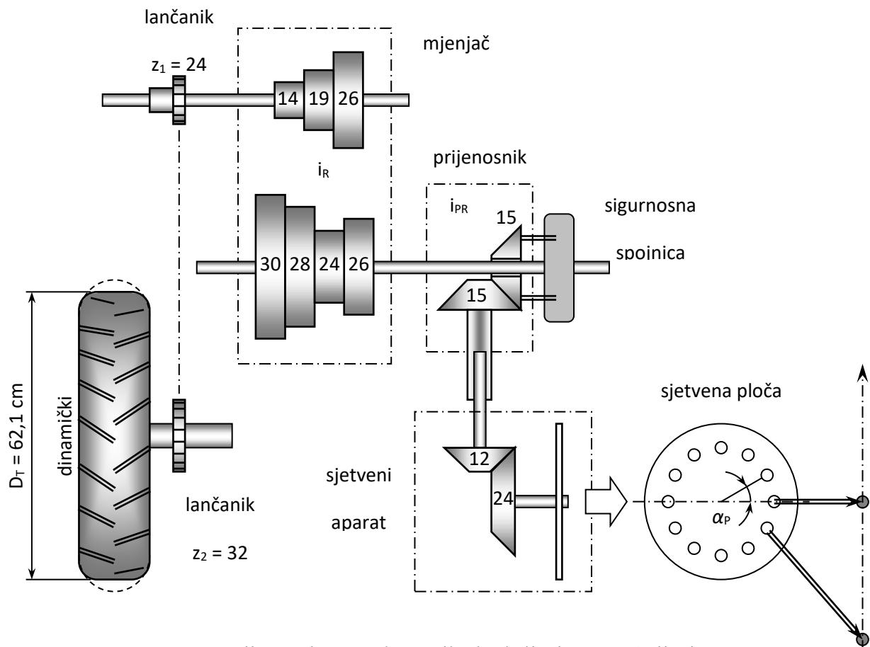
Slika 10. Prijenosni sustav lančanika kod sijačice PSK4 sijačice
