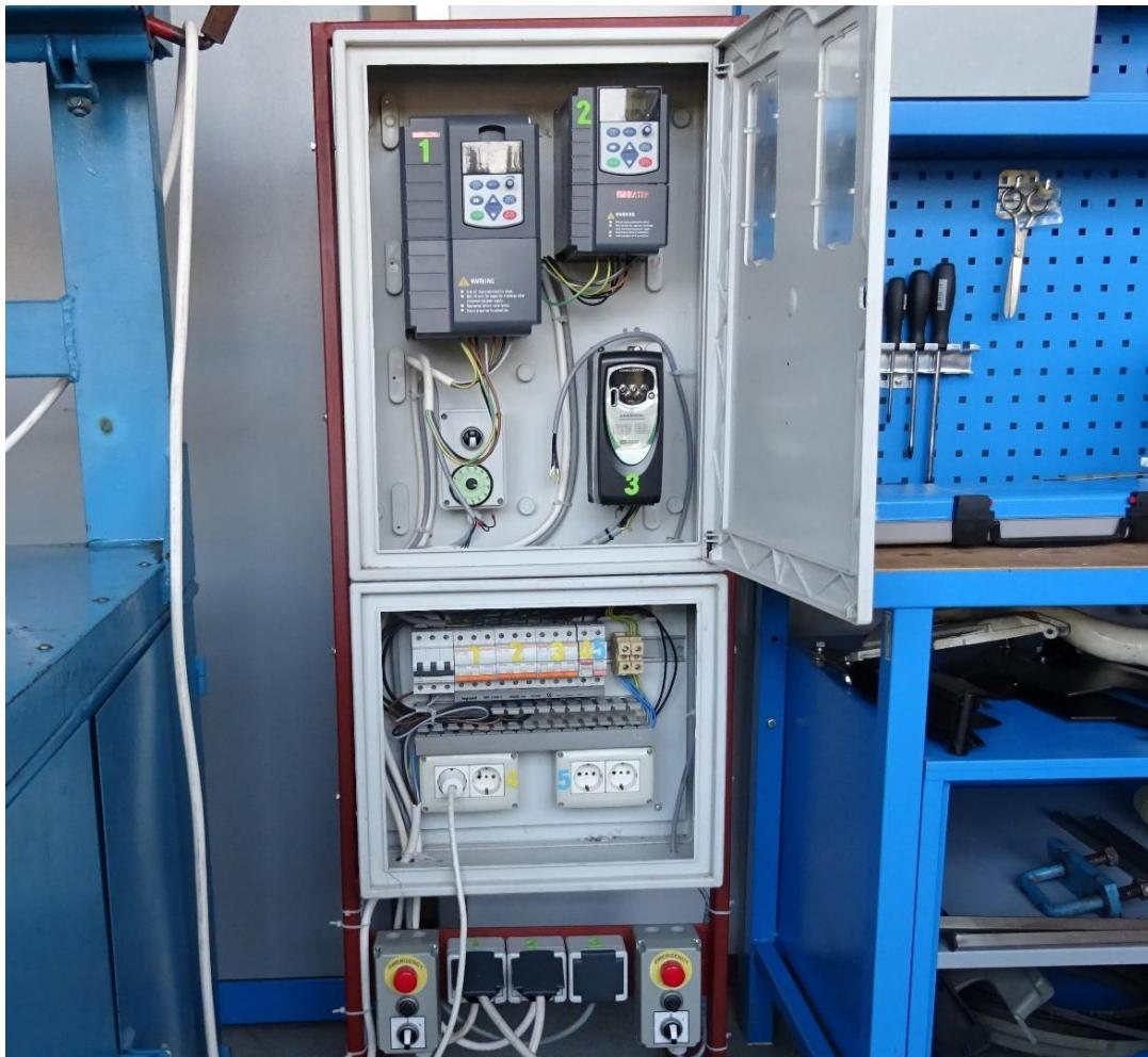
Slika 2. Statički frekventni regulator
