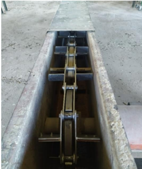
Slika 14. Korito lančastog transportera Kovinar (Izvor: Vlastita fotografija)
