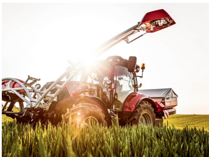
Slika 22. Senzor usjeva agregatiran s traktorom u prihrani
