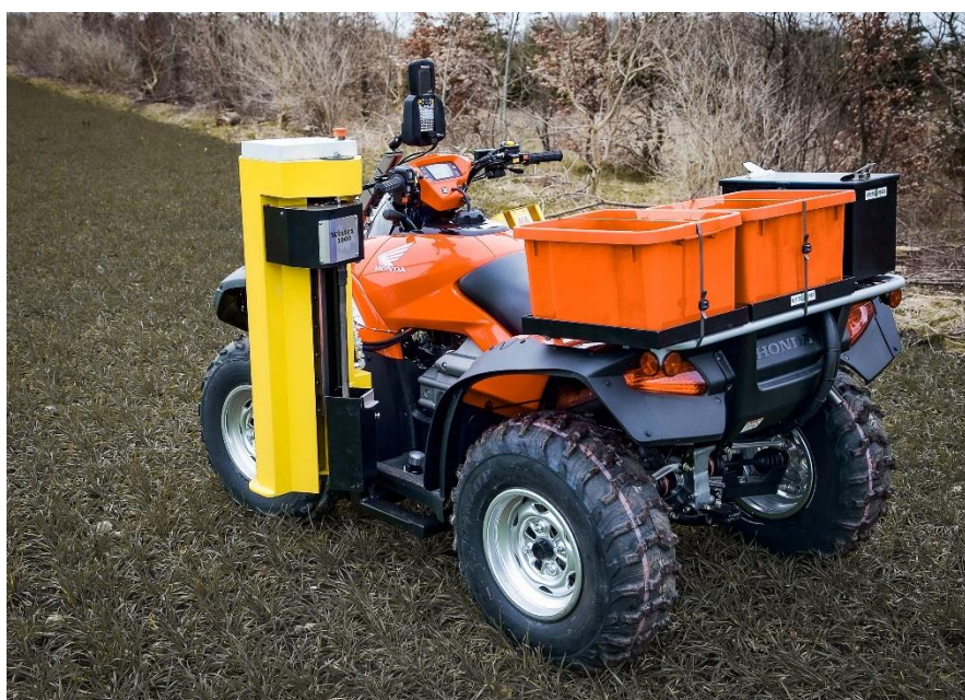
Slika 4. Vozilo opremljeno uređajem za uzimanje uzoraka
