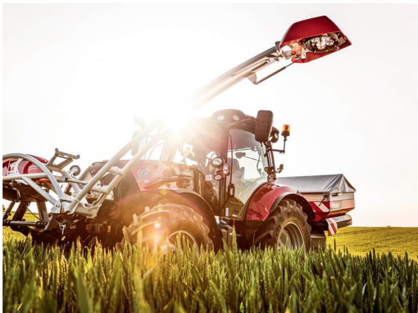
Slika 22. Senzor usjeva agregatiran s traktorom u prihrani
