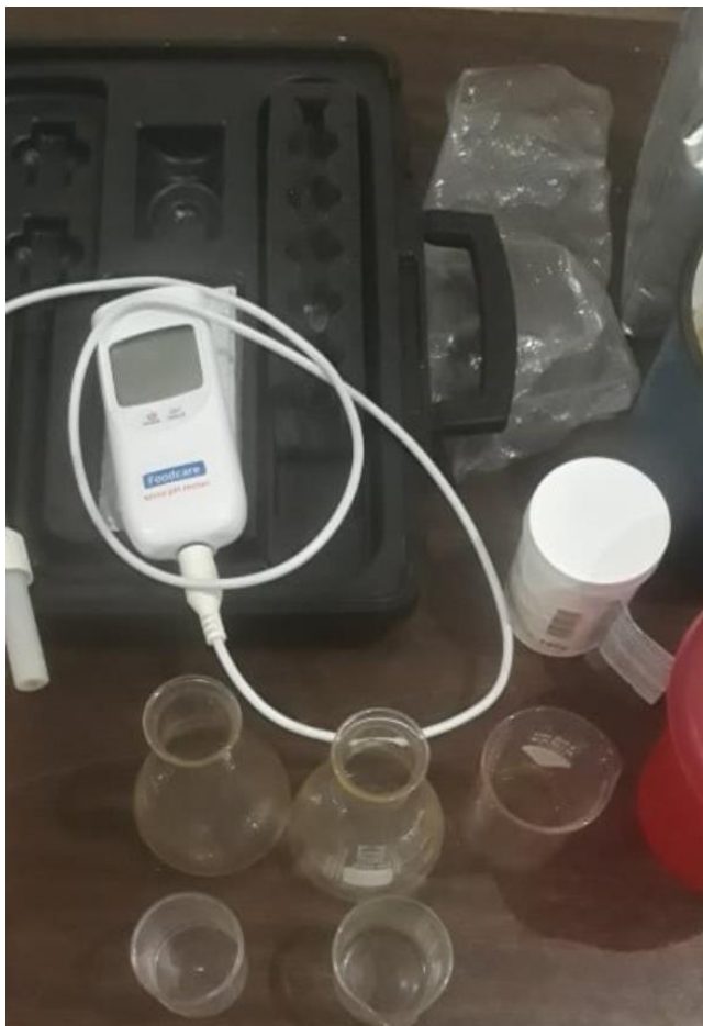
Slika 6. prijenosni pH metar za vino HI99111 (Izvor: F. Klanac)
