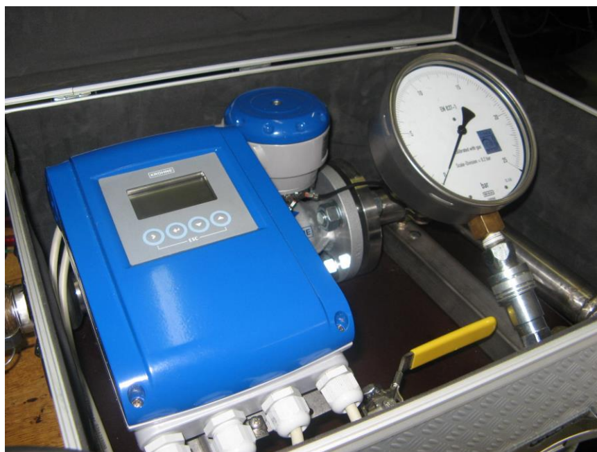
Slika 7. Mjerenje protoke crpke
