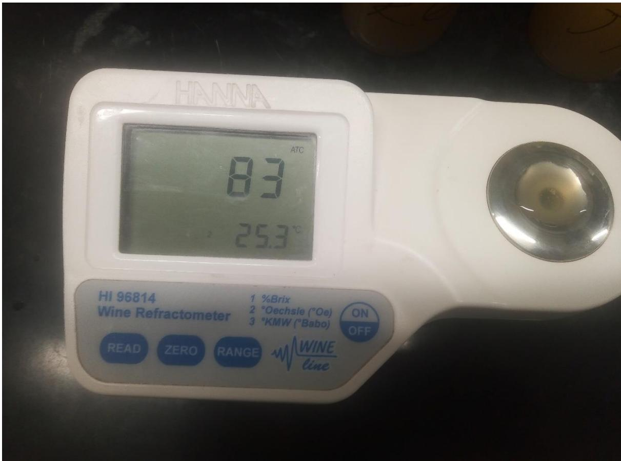
Slika 10. Digitalni refraktometar korišten u pokusu (Izvor: Zetaković, 2019.)
