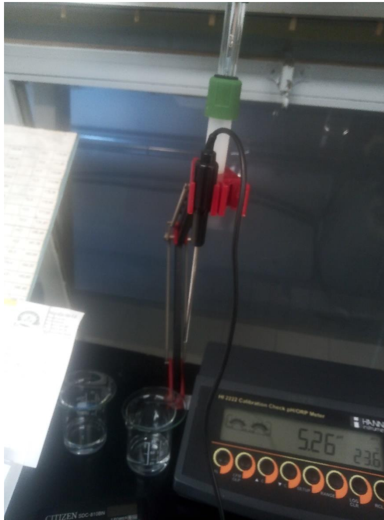
Slika 11. pH-metar korišten u pokusu (Izvor: Zetaković, 2019)
