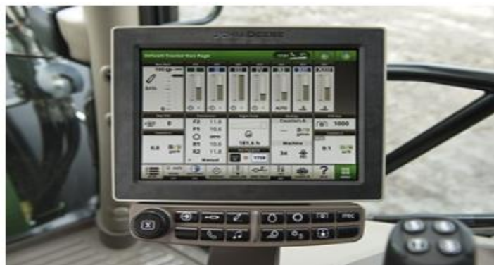
Slika 12. Zapovjedni centar 4200 Gen 4 (Izvor: https://www.smallridgebros.co.uk )
