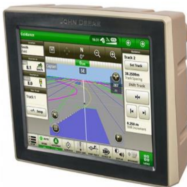
Slika 13. 4240 Gen 4 Univerzalni zaslon
