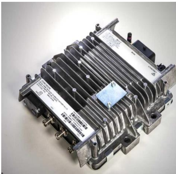
Slika 10. MTG 4LTE Telematski uređaj (Izvor: https://www.deere.com )
