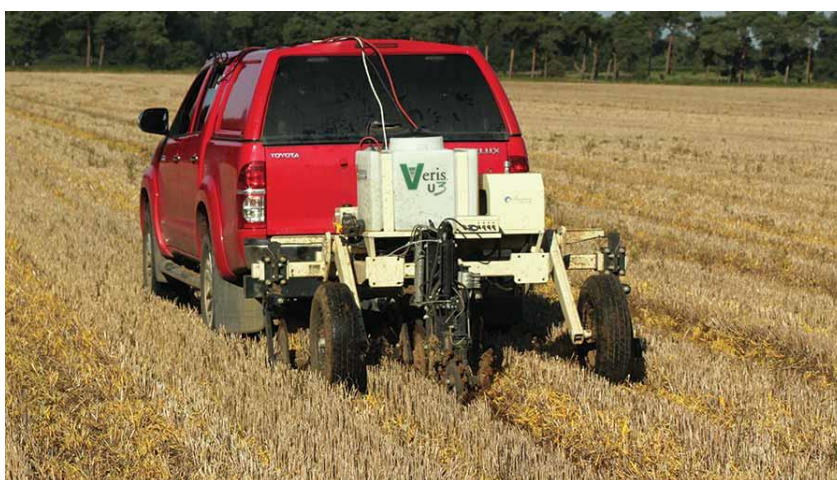
Slika 3. Skener tla (Izvor: https://fwi.co.uk )
