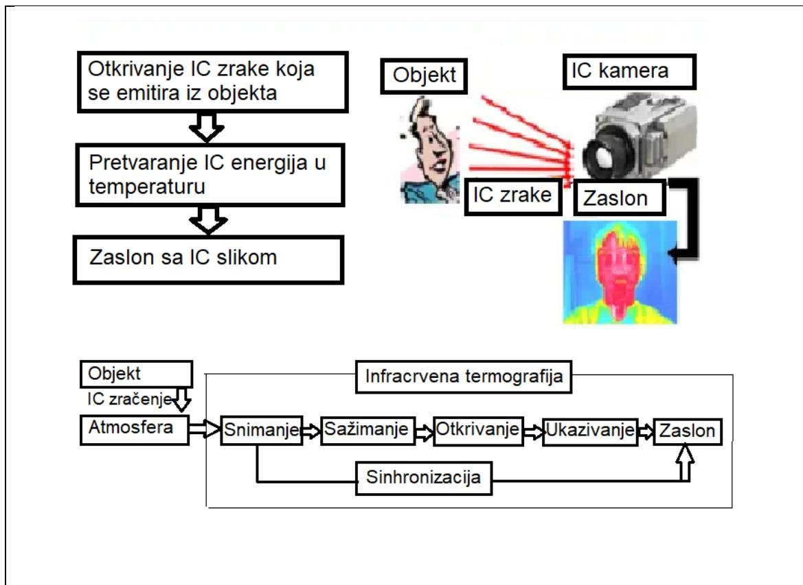
Slika 1. Princip rada infracrvene kamere i termografije
