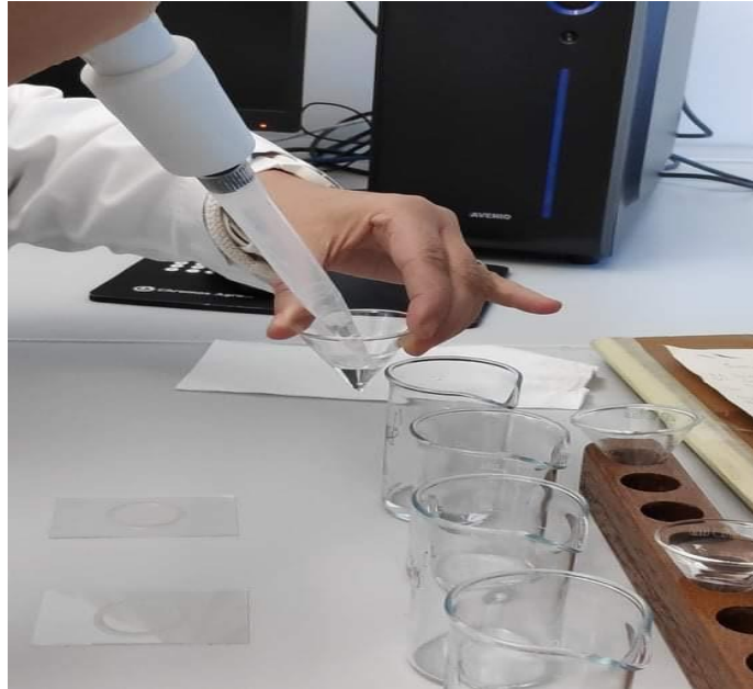
Slika 6. Odvajanje sedimentirane vode
