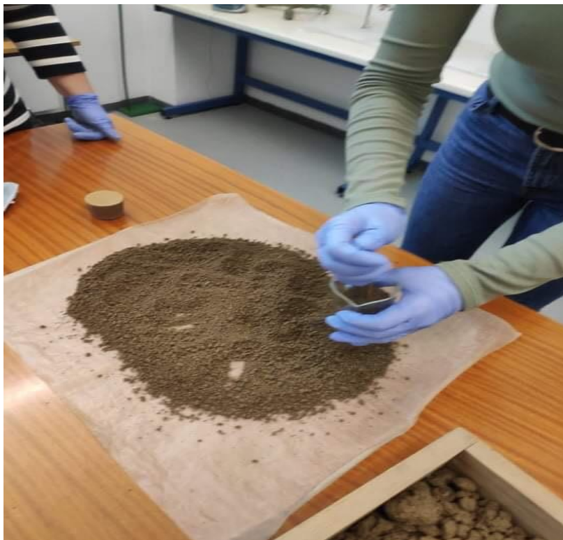
Slika 4. Odvajanje tla za uzorkovanje
