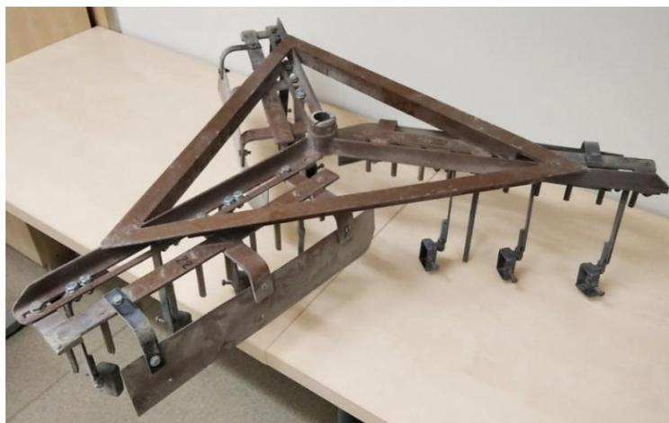
Slika 19. Trokraki nosač uzoraka s držačima uzoraka za ispitivanje trošenja
