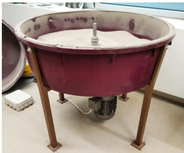
Slika 15. Uređaj za ispitivanje trošenja gibanjem uzoraka u masi abraziva (Izvor: Šalov, 2021.)
