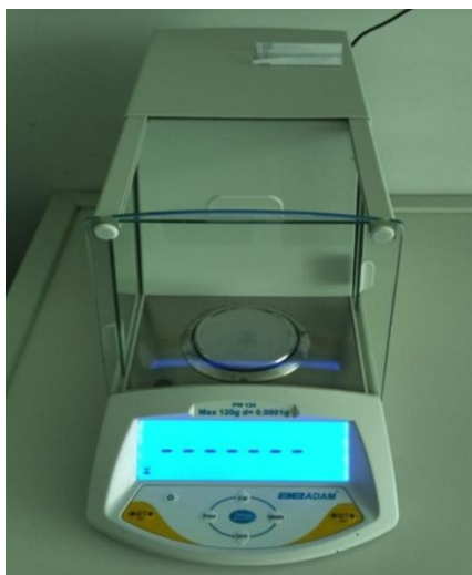
Slika 21. Analitička vaga Adam PW 124
