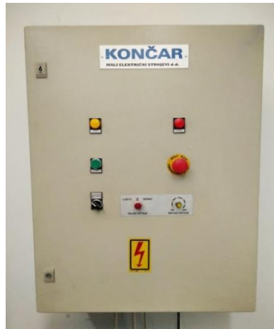
Slika 17. Upravljački dio uređaja za ispitivanje trošenja gibanjem uzoraka u masi abraziva (Izvor: Šalov, 2021.)
