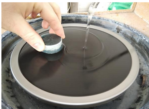
a) Brušenja uzoraka čelika 42CrMo4
