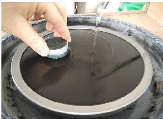
a) Brušenja uzoraka čelika 42CrMo4
