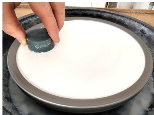
b) Poliranja uzoraka čelika 42CrMo4
