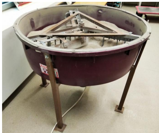
Slika 18. Radni dio uređaja za ispitivanje trošenja gibanjem uzoraka u masi abraziva (Izvor: Šalov, 2021.)
