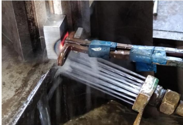
Slika 26. Indukcijsko površinsko kaljenje ispitnih uzoraka čelika 42CrMo4
