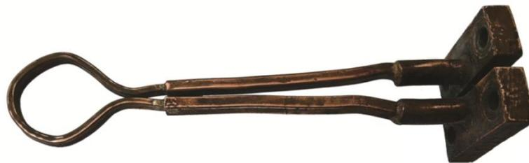
Slika 4. Jednovojni induktor (svitak)
