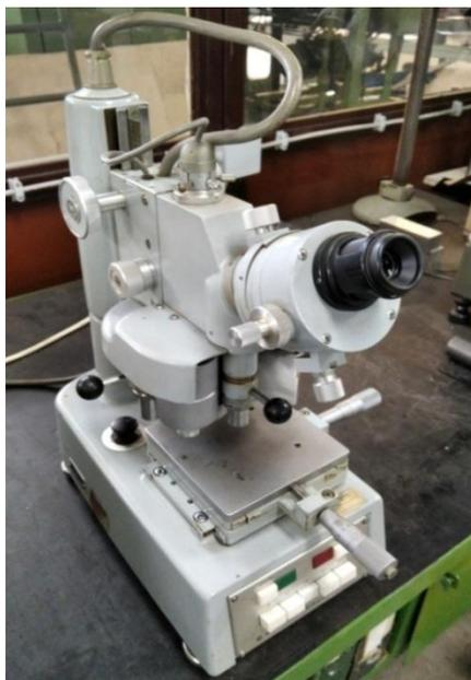
Slika 33. Mikroskop za ispitivanje tvrdoće po Vickersu tvrtke Shimadzu Corporation
