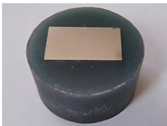
Slika 32. Pripremljen uzorak za ispitivanje mikrotvrdoće po Vickersu čelika 42CrMo4
