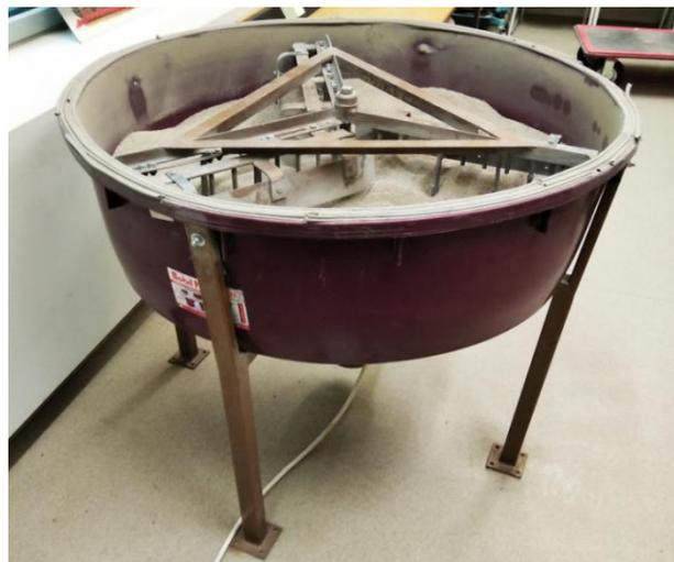
Slika 18. Radni dio uređaja za ispitivanje trošenja gibanjem uzoraka u masi abraziva
