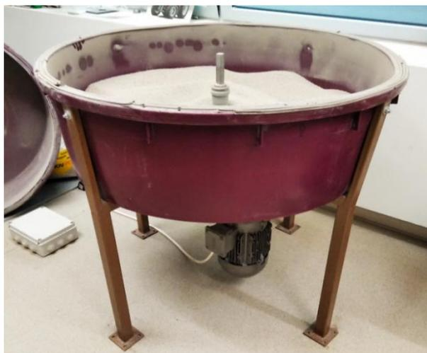
Slika 15. Uređaj za ispitivanje trošenja gibanjem uzoraka u masi abraziva
