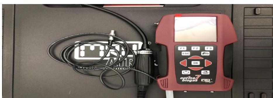
Slika 22. Prijenosni analizator bioplina
