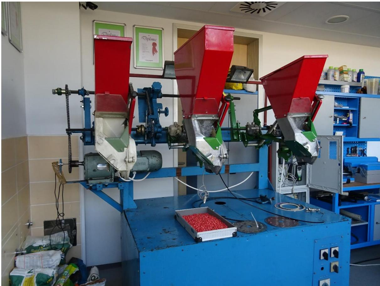
Slika 9. Ispitni stol za pneumatske sijačice
