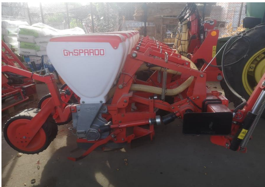
Slika 3. Prikaz sjetvenog aparata u osnovnoj opremi kod sijačice GASPARDO SP
