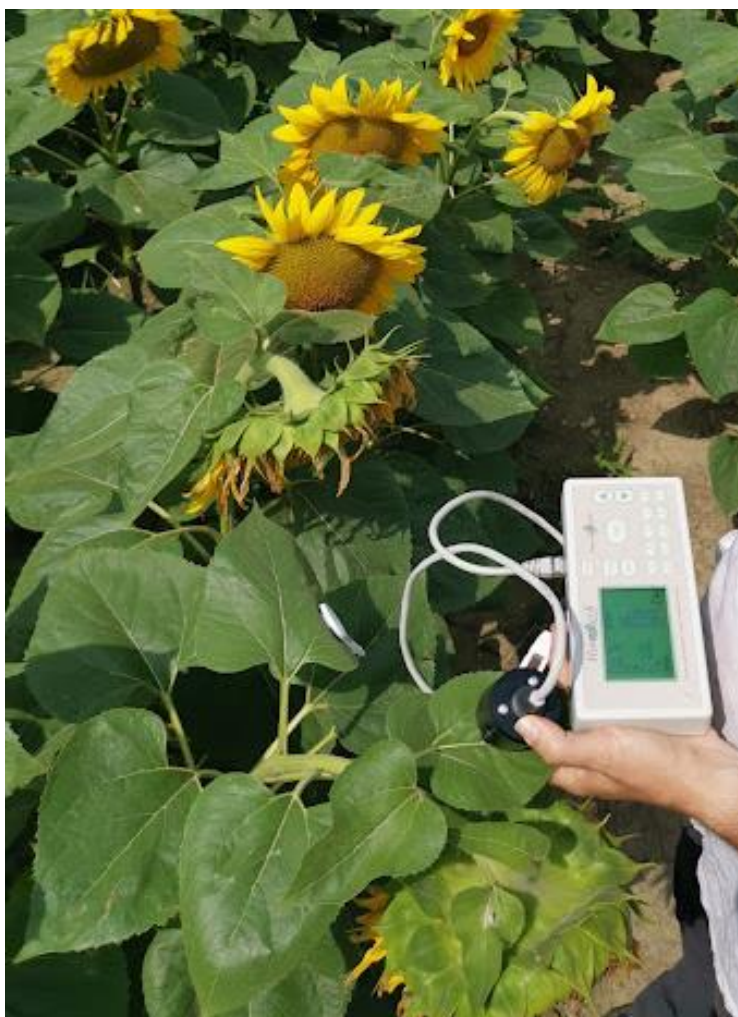
Slika 4. Uređaj Handy PEA za mjerenje fluorescencije klorofila a (Varga, I.)
