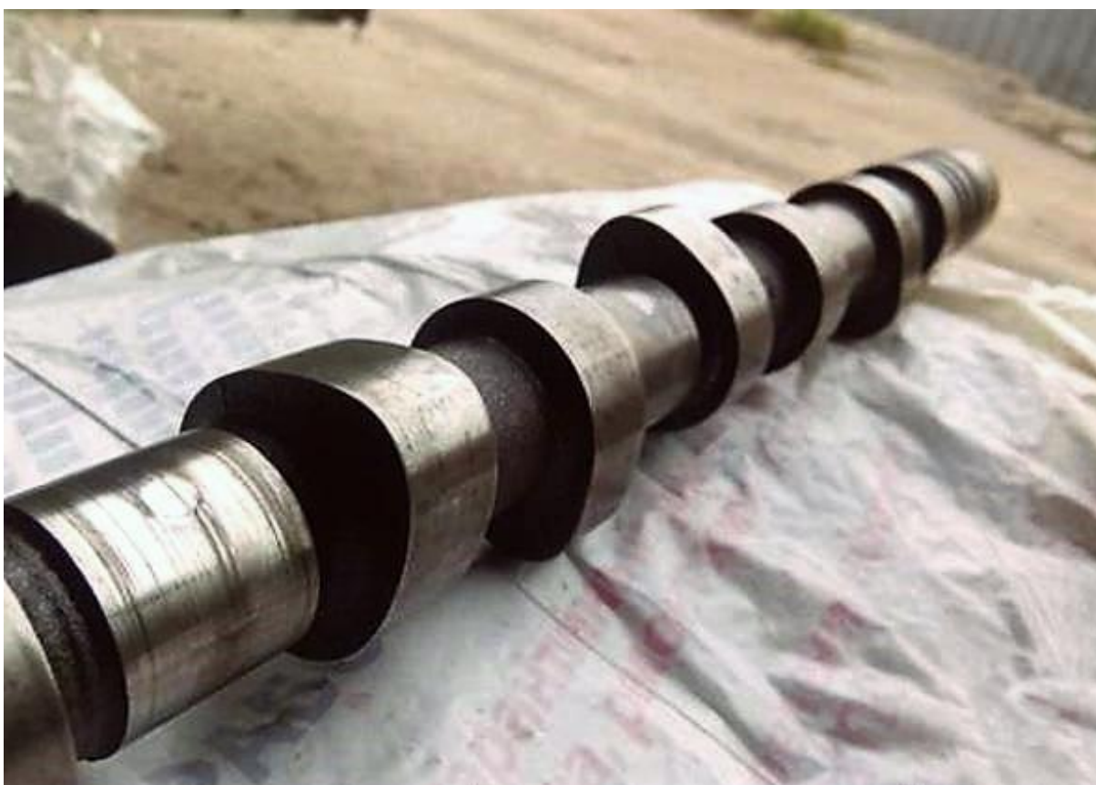
Slika 15. Primjena cementiranja na bregastom vratilu traktora Fendt (Radić, 2021.)
