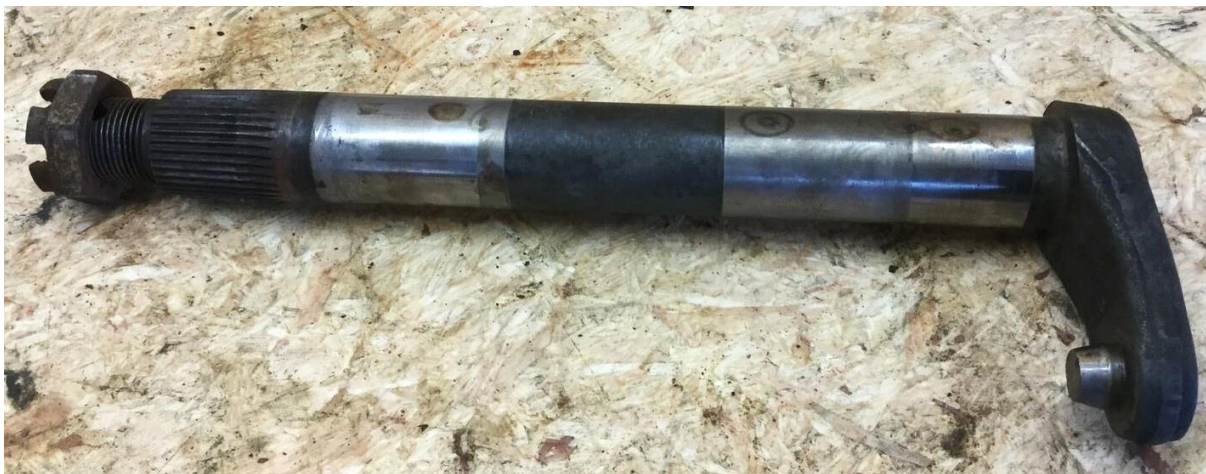
Slika 18. Primjena cementiranja na poluzi upravljača traktora Fendt (Radić, 2021.)
