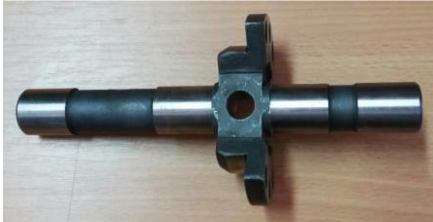
Slika 15. Vratilo diferencijala motokultivatora Goldoni (Fotografija: Šakota, 2021.)
