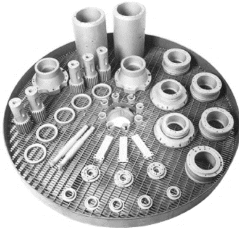
Slika 11. Razni strojni dijelovi kojima je potrebno nitriranje (Izvor: https://www.hot-online.de/heat-treatment-nitriding/ )
