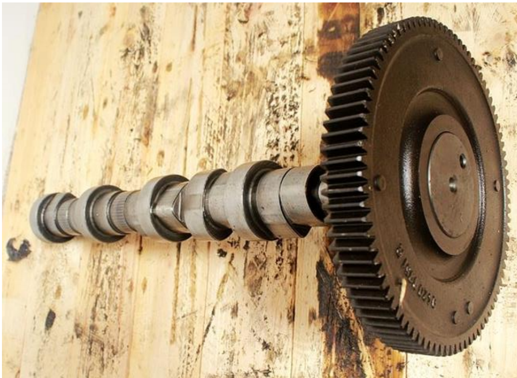
Slika 13. Bregasto vratilo traktora Fendt (Fotografija: Šakota, 2021.)
