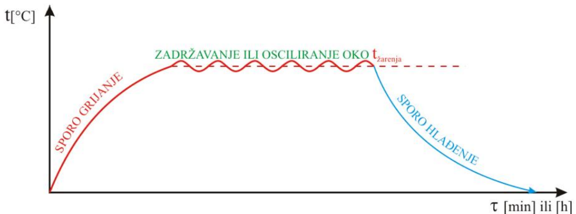
Slika 5. Dijagram toplinske obrade žarenja (Izvor: Deželić, 1988.)
