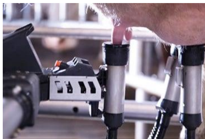
Slika 15. Robotska ruka i postavljanje sisinih čaša na sise vimena krava
