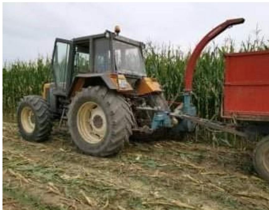
Slika 23. Silažni kombajn *MENGELE 300* i traktor *Renault 180-94 TZ*
