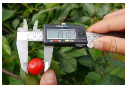
Slika 9. Mjerenje dimenzija ploda digitalnim pomičnim mjerilom (Foto: Vuković, 2013)
